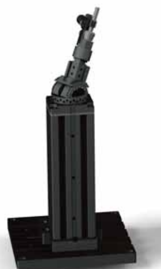
Vorrichtung in Säulenbauweise auf Fußplatte
