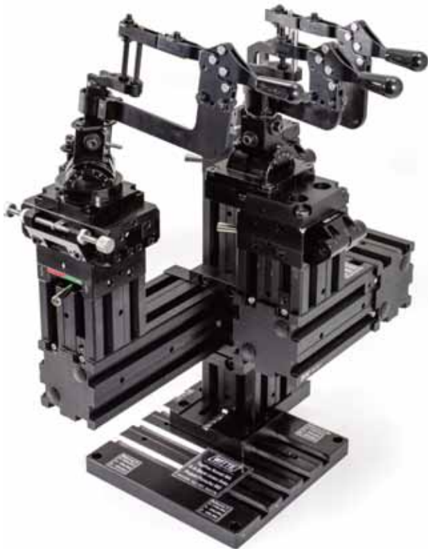
Eine zentrale Säule mit mehreren seitlich angeordneten Adaptionen auf Fußplatte
