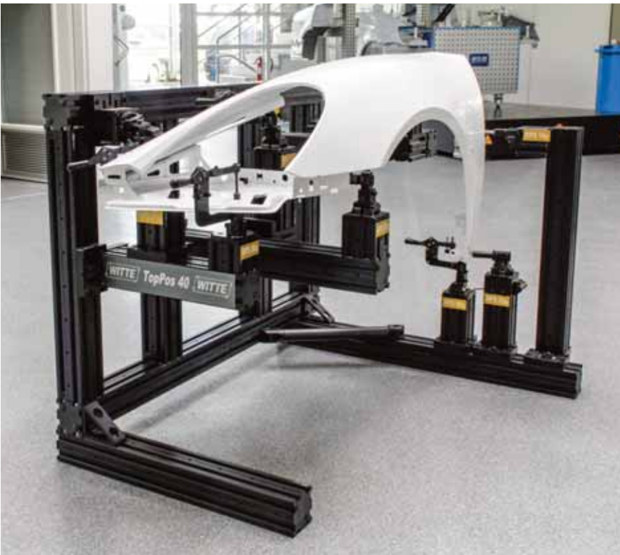
Spannvorrichtung für Kotflügel in Rahmenbauweise
